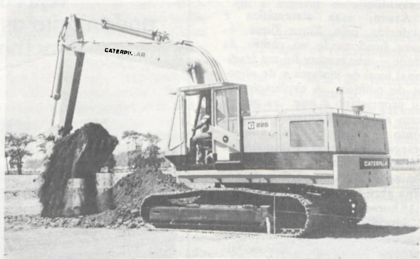
Tanto uma quanto outra têm sistema hidráulico de fluxo variável, bastante superior ao sistema de fluxo fixo das escavadeiras normalmente encontradas no mercado. Os motores são de fabricação própria da CATERPILLAR — como sempre acontece em todo equipamento nosso.
