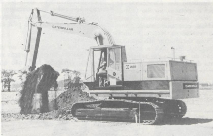
Tanto uma quanto outra têm sistema hidráulico de fluxo variável, bastante superior ao sistema de fluxo fixo das escavadeiras normalmente encontradas no mercado. Os motores são de fabricação própria da CATERPILLAR — como sempre acontece em todo equipamento nosso.
